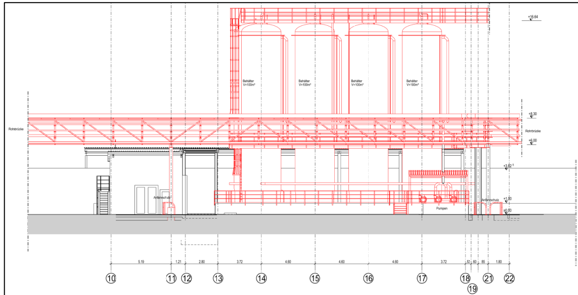
Abbildung 3-5: Ansicht Süden des Tanklagers I und Rohrbrücke (Quelle: IA Tech, Genehmigungsplanung 2016)
